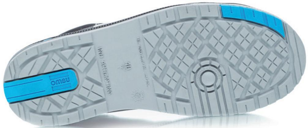
**Planta exterior :** Cuenta con canales longitudinales para favorecer la tracción y el agarre absorbiendo en el ancho las irregularidades del terreno. Los canales transversales permiten el movimiento controlado de la torsión. Cuenta con un dibujo antideslizante y auto-limpiante. Posee insertos en TPU, dispuestos en zonas específicas para mejorar el Grip.
